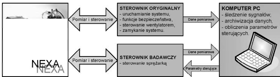
Rys. 3. Schemat przepływu informacji na stanowisku badawczym Fig. 3. The test bed information flow diagram
